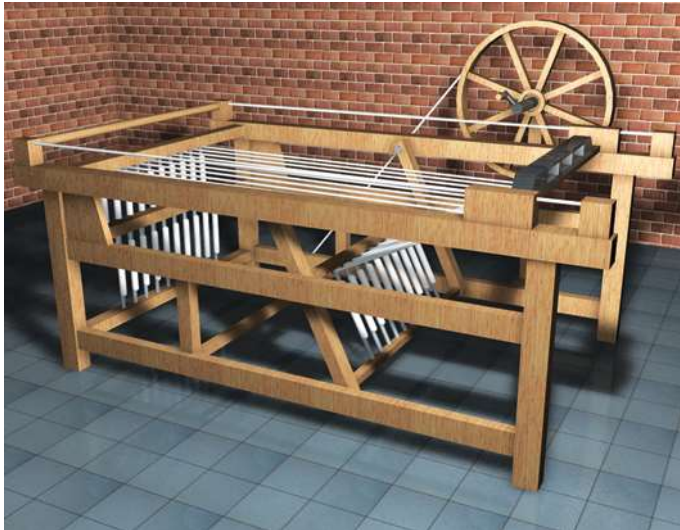
Hiladora o máquina de hacer hilos de Hargreaves (Jenny), abarató la capacidad de transformar el algodón en hilos continuos.
